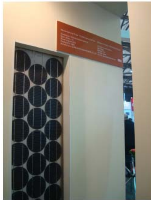
日地电力光伏组件 以Tedlar®2000系列PV膜为主要特色 尺寸：1356mm × 296mm × 40mm 规格：单晶硅 输出功率：35W 产于1988年
